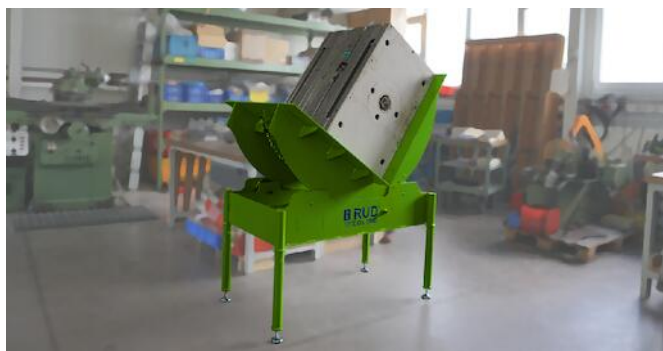
TMB Werkbank/kanteltable voor werkstukken van 20-2000 kg
